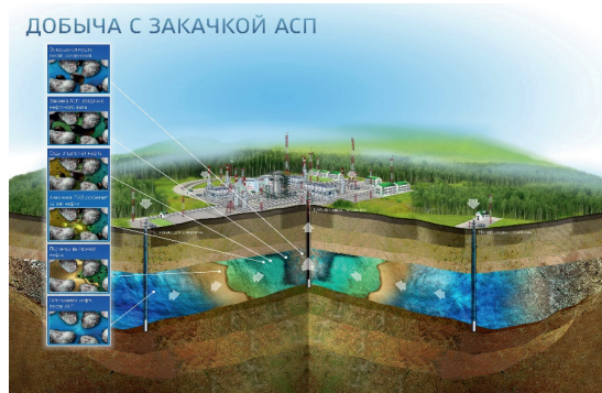
Рисунок 3.6 — Добыча с закачкой ASP
