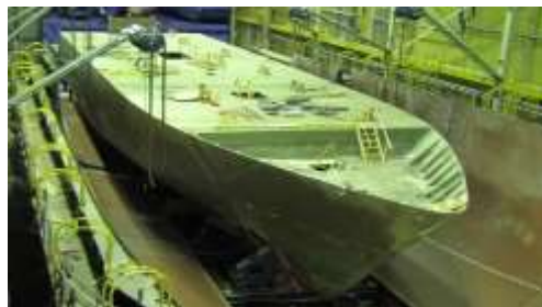
Корпус из монолитного стеклопластика
