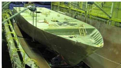
Корпус из монолитного стеклопластика
