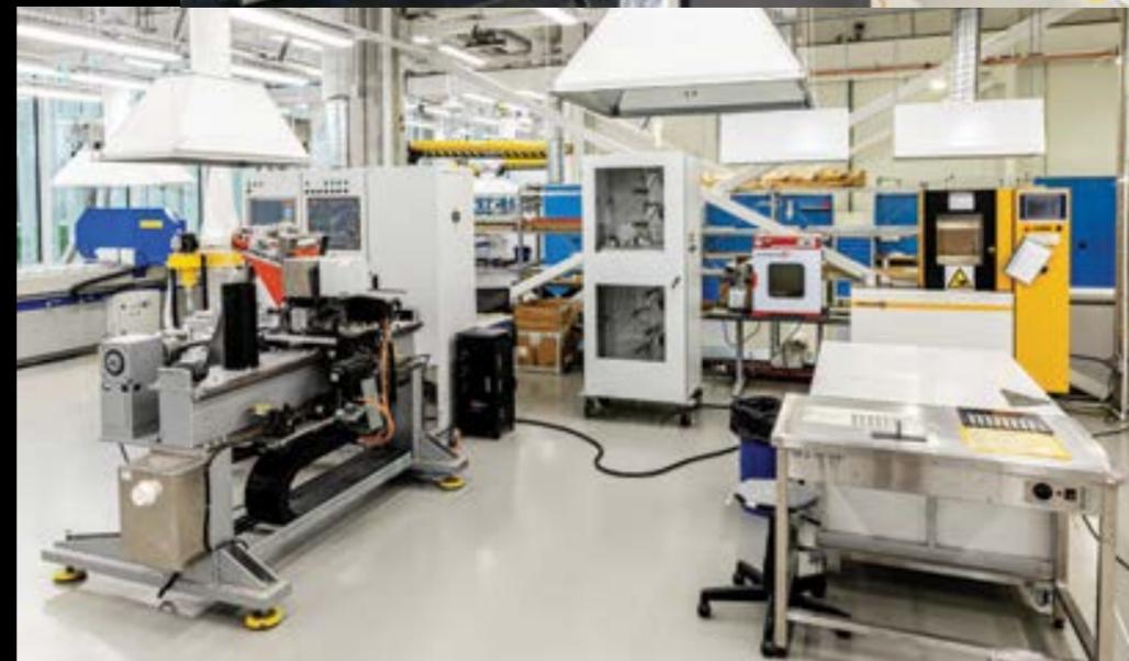
В лаборатории проводят перспективные исследования в областях газотермического напыления и 3D-печати, включая современные методы получения новых комбинированных материалов и сложных изделий; прототипирование узлов и агрегатов, невозможных традиционными методами механической обработки, а также ведут поиск методов улучшения прочности и износостойкости покрытий, получения наноразмерных плёнок методами осаждения с помощью газовой или плазменной струи.
