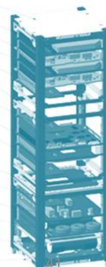
Structure of the «CosmoAIS» nanosatellite
